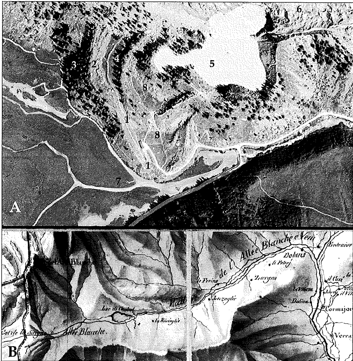
fig. 17 – A: Veduta aerea del sito di Combal in val Vény (elab. dell'A.): (1) Percorso dei trinceramenti del 1743 e 1793 dal margine inferiore dell'argine glaciale di Combal a circa metà altezza; si scorgono l'articolazione a redan del primo tratto inferiore e lo sviluppo rettilineo ascendente con un redan centrale; (2) Tratto superiore dei trinceramenti lungo l'argine glaciale; (3) Tratto inferiore a sud-ovest dell'argine glaciale, chiuso nel bosco di conifere; (4) Grande spazio semilunato in piano nel letto antico di un ramo del ghiacciaio, adibito ad accampamento e protetto dall'epaulement semicircolare; (5) Lago glaciale presso il limite inferiore del ghiacciaio di Miage; (6) Ghiacciaio di Miage; (7) Antico letto del lago di Combal, contenuto nel 1743 e nel 1793 dalla diga realizzata in legname presso la strettoia antistante il margine inferiore curvo dell'argine glaciale; B: Il sistema difensivo della val Vény dal Col de la Seigne fino a Courmayeur, con i trinceramenti e il lago di Combal, poco a valle del ghiacciaio di Miage, assai più esteso nel XVIII secolo rispetto ad oggi, dalla Carta del Ducato d'Aosta colle posizioni militari di Giuseppe Riccio (elab. dell'A.; Archivio di Stato di Torino, Sezione di Corte, Carte topografiche e disegni, Carte topografiche segrete, Aosta A 13 NERO).
