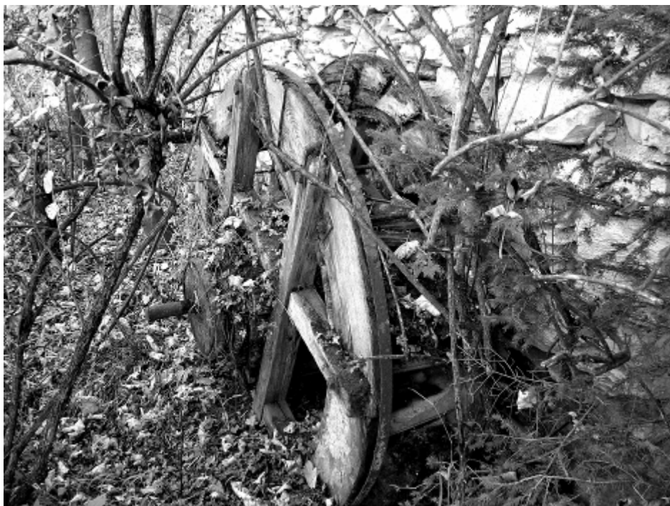
Fig. 6) Ruota verticale, presso la Fucina Inverso, a Beaulard. Dall'inclinazione delle fessure d'alloggiamento delle pale si può capire che la ruota veniva colpita dall'acqua "per di sopra".
